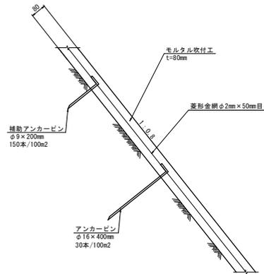
※水抜きパイプVPφ50を2m2に1箇所設置すること。
