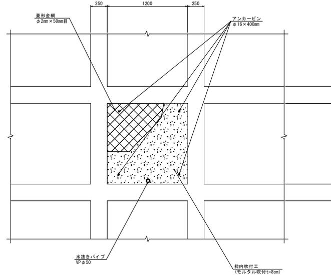
※既設種生基材が露出した箇所にモルタル吹付工(t=8cm)を施工する。
